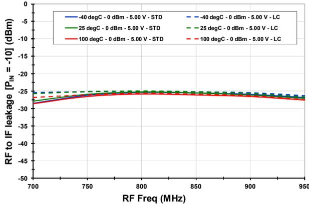
RF-IF Leakage vs. V<sub>CC</sub>
